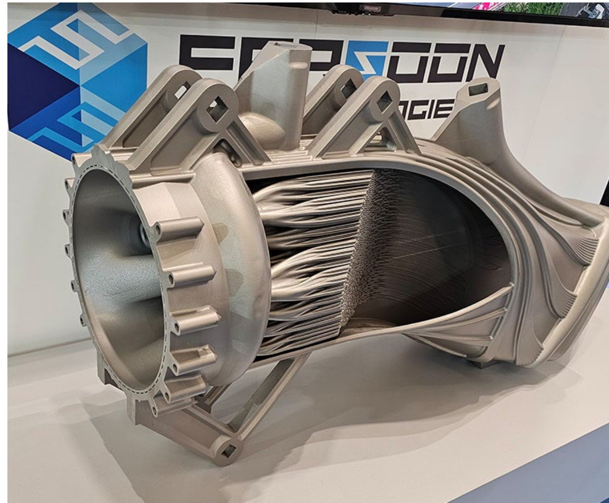
Osa: Hypersonic Precooler, Valmistaja: Farsoon, LEAP71 Materiaali: 316l, Laite: FS811M-U-8, pituus: 1.5 metriä
